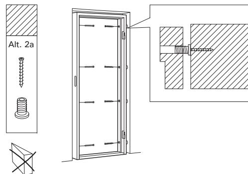
**Alt.2a Материал стены: дерево. Используемая монтажная фурнитура: саморезы, гильзы.**
