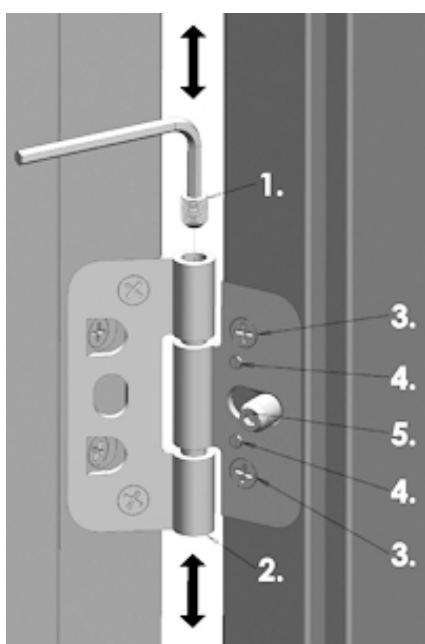
Для регулировки двери по высоте используйте шестигранный ключ. Перед регулировкой двери в сторону ослабьте противовзломные штыри и крепежные шурупы. Регулировку в сторону выполняйте предназначенным для этого регулировочным винтом.
