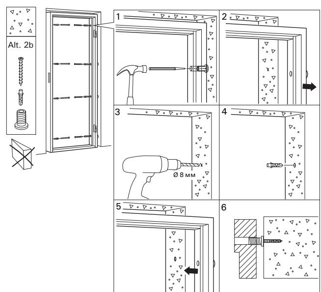
**Alt.2b Материал стены: бетон. Используемая монтажная фурнитура: саморезы, гильзы.**
